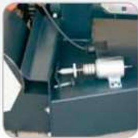
Cierre automático de la entrada de aire primario.
